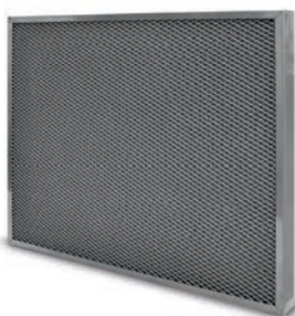
Vetvang metaalfilter Afscheiden van vet of olienevel. Materiaal: RVS of aluminium. Kwaliteitsklasse ISO Coarse.
