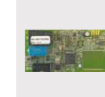
ISM8i Modul pripojovacieho rozhrania s OPEN SOURCE protokolom TCP/IP
