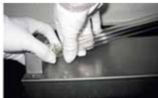
1. UVC fluorescentnu cijev utaknite u utičnicu
