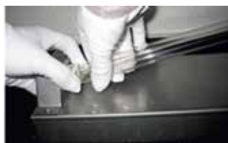
1. Introduceți tuburile fluorescente UVC în fasung
