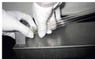
1. UVC-lichtbuizen in de fitting steken
