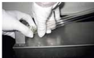
1. Työnnä UVC-valoputket kiinnikkeisiin
