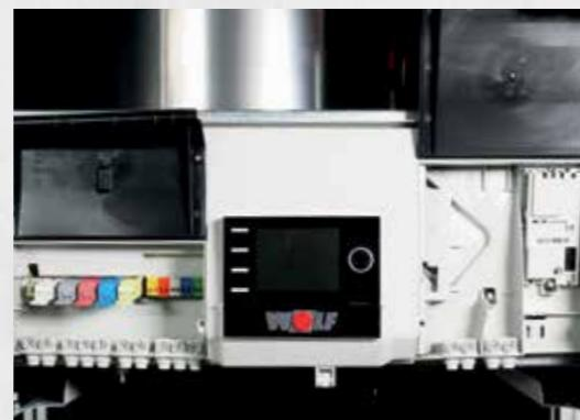
Riadaci systém bol od základu prepracovaný a optimalizovaný. Všetky dosky s plošnými spojmi sú inštalované v jednej skrinke, spolu s priestorom pre voliteľné moduly Wolf Link Home a E-A. Integrované káblové kanály a centrálné káblové priechodky v spaľovacej komore umožňujú ľahký prístup ku všetkým komponentom počas inštalácie a údržby.
