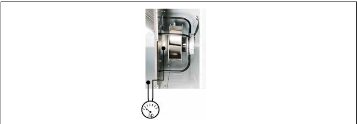
Fig. 7.1 Medición de la presión diferencial
