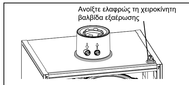
Εικόνα: Χειροκίνητη βαλβίδα εξαέρωσης
