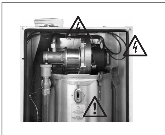
Zapaľovací transformátor, zapaľovacia vysokonapäťová elektróda, výmenník tepla Pozor, elektrické napätie, nebezpečenstvo popálenia horúcimi súčiastkami!
