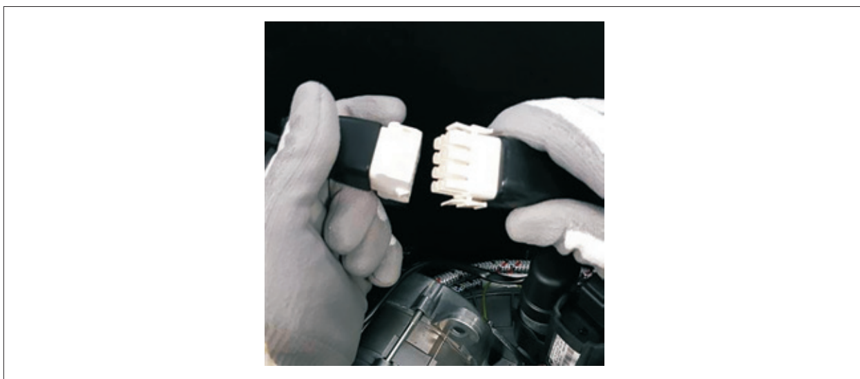
Rys. 4.3 Zdejmowanie wtyczki palnika
