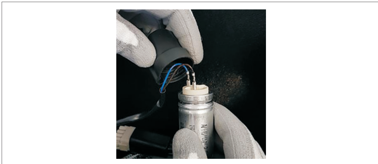
Rys. 4.4 Zdejmowanie zaślepki ochronnej
