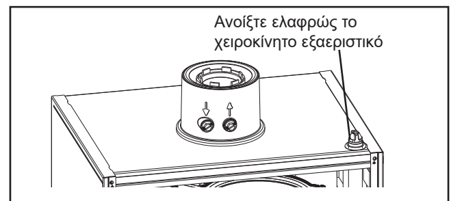
Εικόνα: Χειροκίνητη βαλβίδα εξαέρωσης
