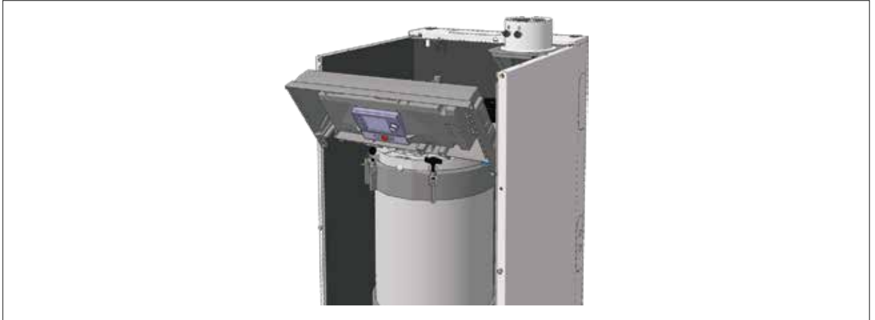
Rys. 6.5 Opuścić skrzynkę sterowania
