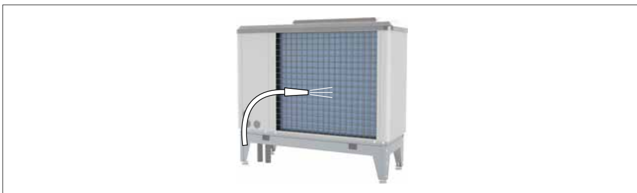
Fig. 5.1 Lado de aspiración de aire
