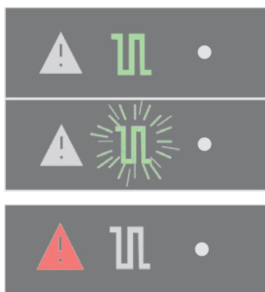
Πίν. 6.2 Καταστάσεις λειτουργίας κυκλοφορητή κυκλώματος θέρμανσης
