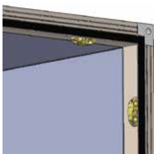
Taśma uszczelniająca gr. 6 mm od wewnątrz
