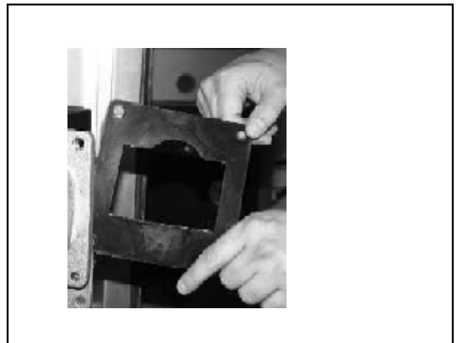
Figura: Extraer la junta del ventilador
