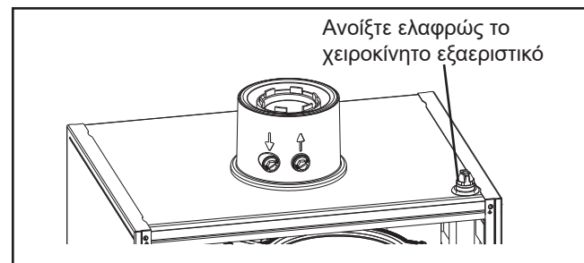
Εικόνα: Χειροκίνητη βαλβίδα εξαέρωσης
